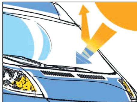
Le pare-brise contient une fine couche d'oxydes métalliques, qui intercepte et réfléchit les rayons infrarouges responsables de la surchauffe de l'habitacle. Il réduit l'effet brûlant du soleil sur les occupants et la température à l'intérieur de l'habitacle, diminuant ainsi l'utilisation de la climatisation et donc également la consommation.
