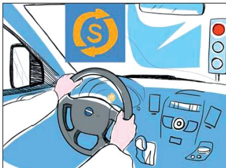
Start&Stop est le système qui éteint automatiquement le moteur lorsque les conditions de circulation imposent un arrêt du véhicule, par exemple les feux rouges, les bouchons, les arrêts temporaires. Le moteur est ensuite redémarré en appuyant sur la pédale d'embrayage. Pensé en particulier pour les déplacements en ville, il est en mesure de garantir jusqu'à 15 % d'économies de carburant, ce qui réduit sensiblement les émissions également.
