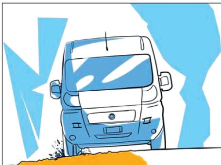
Le système innovant de contrôle Traction+ augmente la motricité du véhicule sur des terrains difficiles et présentant une faible adhérence. En cas de faible adhérence voire d'absence d'adhérence sur une roue motrice, la centrale du système relève le patinage et la freine, transférant le couple moteur sur la roue ayant une meilleure prise sur le terrain. De cette façon le désengagement du véhicule devient plus facile tout en garantissant les meilleures maniabilité et stabilité possibles.
