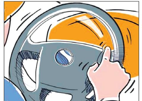
Le système augmente le confort de conduite, facilitant également les manœuvres de stationnement lorsque le véhicule est à l'arrêt et à pleine charge. La direction assistée à asservissement variable réduit quasiment de moitié l'effort sur le volant par rapport à une direction assistée normale. Dans le même temps, il garantit une précision maximale à vitesse élevée, adaptant l'effort du conducteur de manière progressive.
