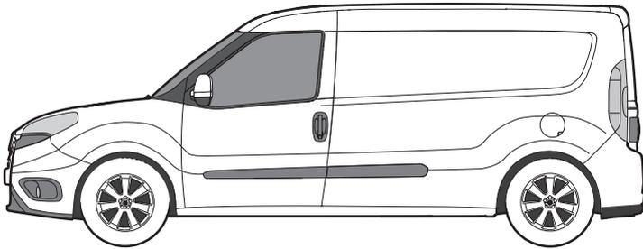
**KASTENWAGEN MAXI** | RADSTAND: 3.105 mm | FAHRZEUGLÄNGE / FAHRZEUGBREITE: 4.756 mm / 1.832 mm
