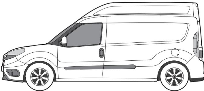
**KASTENWAGEN MAXI XL** | RADSTAND: 3.105 mm | FAHRZEUGLÄNGE / FAHRZEUGBREITE: 4.756 mm / 1.832 mm
