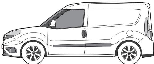
**KASTENWAGEN** | RADSTAND: 2.755 mm | FAHRZEUGLÄNGE / FAHRZEUGBREITE: 4.406 mm / 1.832 mm
