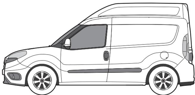
**KASTENWAGEN** | RADSTAND: 2.755 mm | FAHRZEUGLÄNGE / FAHRZEUGBREITE: 4.406 mm / 1.832 mm
