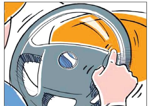
Das System steigert den Fahrkomfort und erleichtert die Parkmanöver auch bei stehendem und voll beladenem Fahrzeug. Die Servolenkung mit variabler Lenkkräft verringert den Kraftaufwand im Vergleich zu einer normalen Hydraulenlenkung um fast die Hälfte. Gleichzeitig wird höchste Präzision bei hoher Geschwindigkeit garantiert, indem der Lenkradwiderstand progressiv gesteigert wird.
