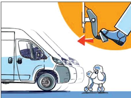
Der Bremsassistent sorgt direkt über den Bremskraftverstärker dafür, dass der Druck im Bremskreis bei einer Vollbremsung automatisch optimiert wird.
