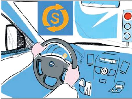
Das System Start&Stop erlaubt, den Motor automatisch abzustellen, wenn die Verkehrsbedingungen ein Anhalten des Fahrzeuges fordern, z.B. vor einer roten Ampel, im Stau oder bei kurzen Halten. Der Motor wird durch Betätigung des Kupplungspedals erneut gestartet. Vor allem im Stadtverkehr bringt dies eine Kraftstoffeinsparung von bis 15%, was sich auch auf die Emissionswerte positiv auswirkt.
