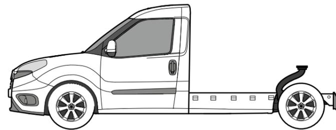
**FAHRGESTELL FLACHBODEN** | RADSTAND: 2.755 mm / 3.105 mm
